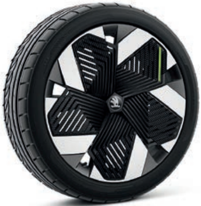
21" kola z lehké slitiny Vision antracitová leštěná s aero kryty* Vpředu: 8,5J × 21" ET40 | 235/45 R21 Vzadu: 9J × 21" ET42 | 255/40 R21
